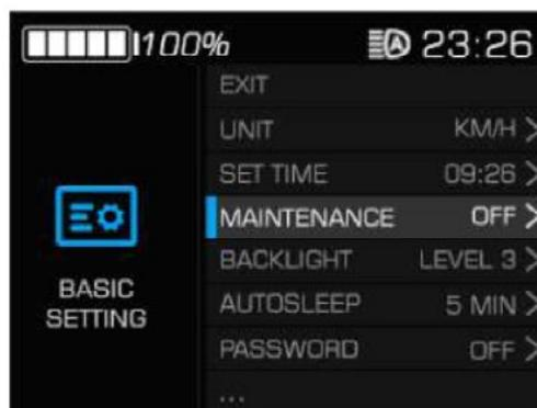
Drücken Sie innerhalb von 10 Sekunden nach dem Einschalten des Displays lange die M-Taste, um die Einstellungen aufzurufen. Drücken Sie kurz die Pfeil-Tasten, um zwischen den Einstellungsmöglichkeiten zu wechseln.
