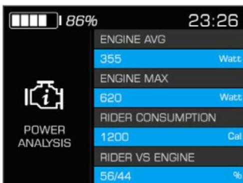
Es werden folgende Motorinformationen angezeigt: Ausgangsleistung des Motors, maximale Leistung des Motors, Leistung von Motor und Benutzer/in
