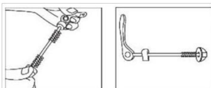
Entfernen Sie die schwarzen Kunststoffabdeckungen links und rechts am Vorderrad, die zur Transportsicherung dienen. Lösen Sie vorsichtig den Kabelbinder an der Speiche mit dem ihre Schnellspannerachse befestigt ist.
