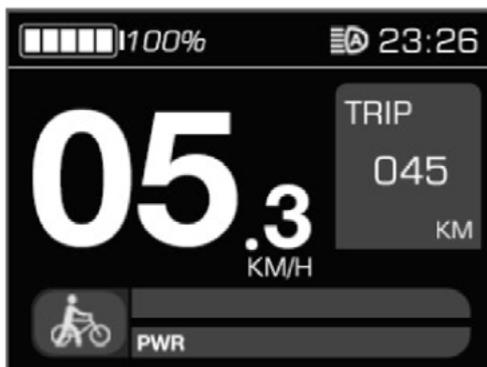
Um die Funktion zu aktivieren, halten Sie die V-Taste gedrückt. Das E-Bike fährt in Schrittgeschwindigkeit (5 km/h) weiter. Die Funktion wird ausgeschaltet, sobald die V-Taste nicht mehr gedrückt wird. Dieser Modus funktioniert nur, indem die V-Taste gedrückt bleibt.
