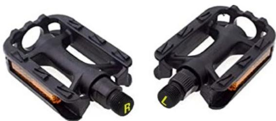
4. Verwenden Sie einen 15-mm-Maulschlüssel, um den Fuß zu verriegeln.
