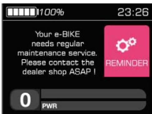
Das Display zeigt eine Wartungserinnerungen über das Display an, sobald der eingestellte Kilometerstand erreicht wird. Die Wartungserinnerung wird angezeigt, sobald 5000 km erreicht werden. Die Benachrichtigung kann durch kurzes Drücken der M-Taste gelöscht werden.
