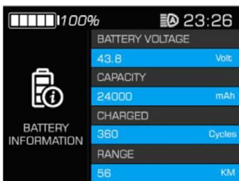
Es werden folgende Akkuinformationen angezeigt: Prozentanzeige, Spannung, Kapazität, Ladezyklen und Reichweite. (Die Batterieanzeige zeigt den Prozentsatz der Batterie nicht an, wenn keine BMS-Informationen verfügbar sind)
