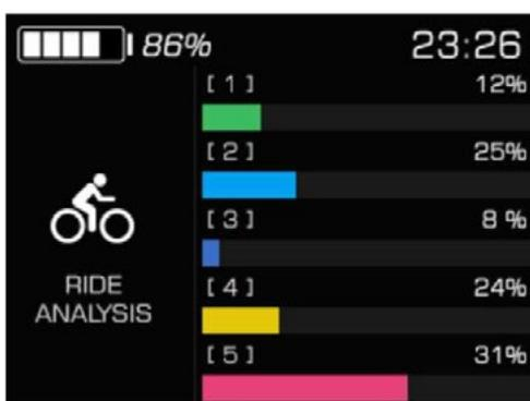
Anzeige der Unterstützungsstufen während der Fahrt: Die Daten werden aus der aktuellen Fahrt berechnet und als prozentuale Angaben angezeigt. Die Daten können zurückgesetzt werden.
