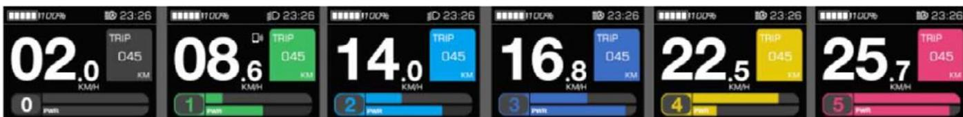
Drücken Sie im normalen Betriebszustand kurz die Pfeil-Tasten, um zwischen den Unterstützungsstufen zu wechseln. **Unterstützungsstufen: 0 - 5**
